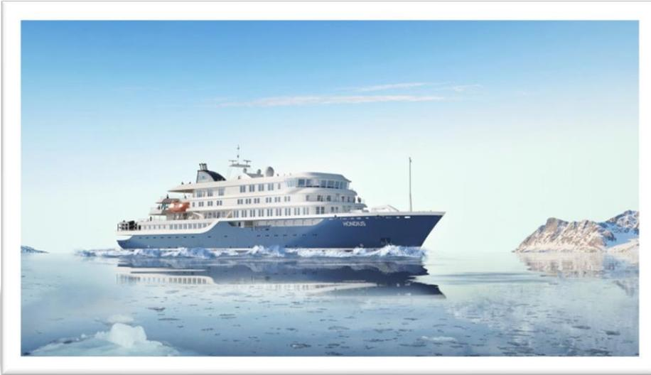
是一艘專為極地建造誕生，最強勁的驅冰船，也是世界上第一艘註冊的 Polar Class 6 船舶，1A-Super 符合最新和最高的勞氏船級社對冰加強遊輪的標準。超越國際海事組織 IMO 採用的極地規則的要求，以最靈活、先進、創新、強勁的驅冰能力，進行全方位徹底進化，弓和船尾推進器、伸縮鰭穩定器，面對大浪能保持最大的
